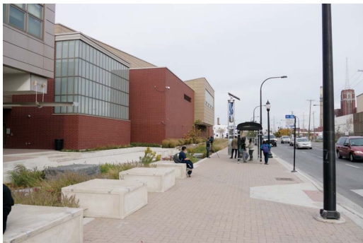
芝加哥瑟马克路旁的生物沼泽地，在暴雨期间可对超负荷下水道中的雨水进行分流
